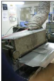
Detalle del proceso de recubrimiento por rodillos
